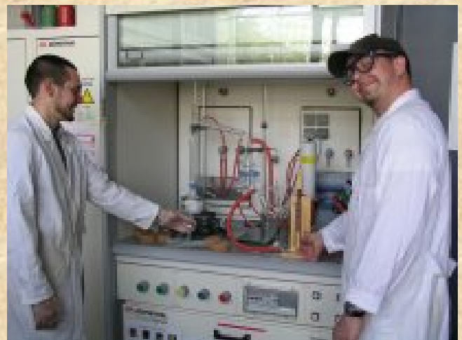
Vakuumdestillation im Praktikum
