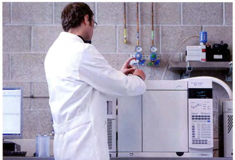
Analyse von Alterungsprodukten am Gaschromatograf mit Massenspektrometer
