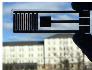
Der pH-Sensor auf Basis von Metalloxiden eignet sich auch für sehr starke Säuren.
