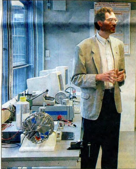
Wie eine Scheibe mit ein paar Drähten (links unten) – so sieht er aus der Elektrolyseur, der im Sommer mit einer Sojus-Rakete in das Weltall abhebt. Professor Peter Kurzweil von der Fachhochschule Amberg-Weiden hat das Gerät mitentwickelt.
