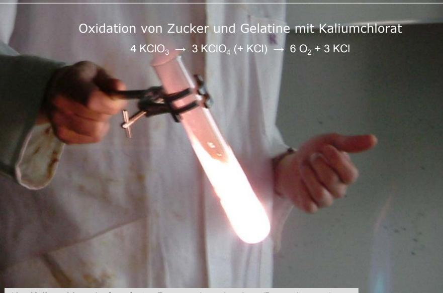
10 g **Kaliumchlorat** im feuerfesten Reagenzglas schmelzen (Bunsenbrenner). Ein Gummibärchen in die Schmelze stoßen.
