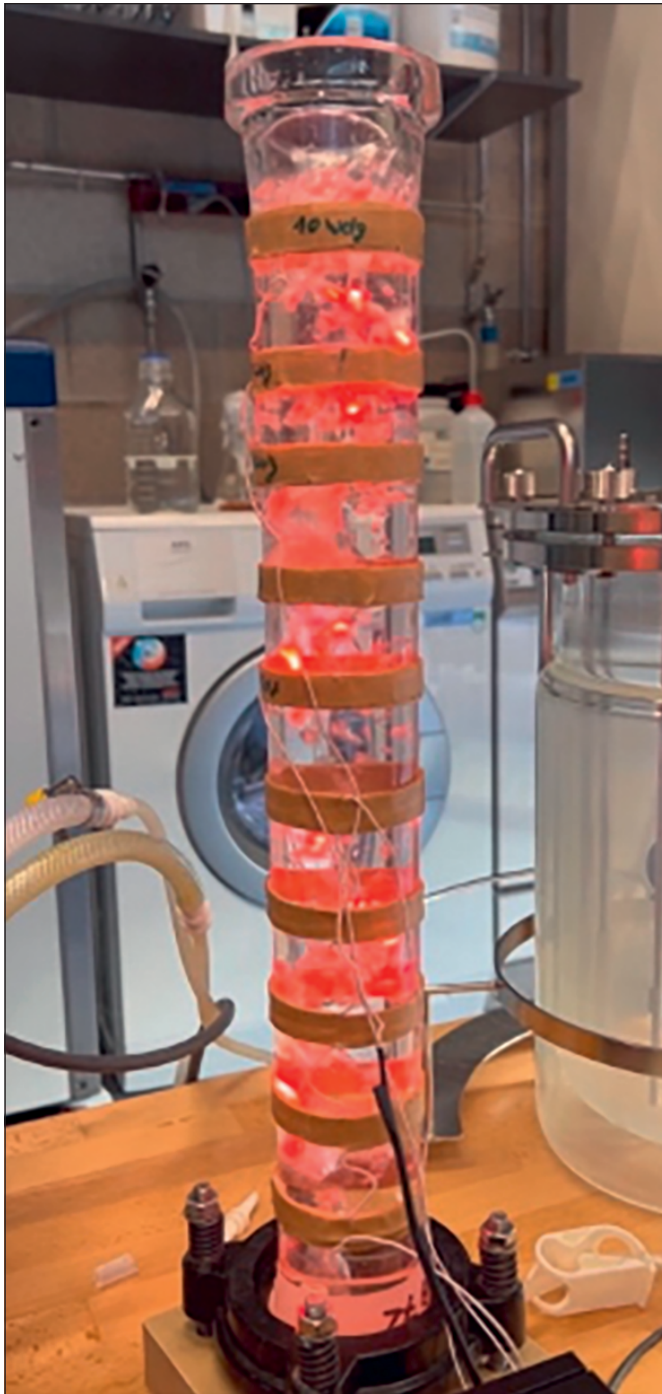
Abbildung 1: Bioreaktor mit WLEs ( d = 50 \text{ mm} )
