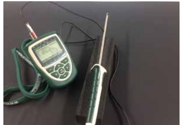
Bild 3: Universalmessgerät der Firma Ahlborn (ALMEMO® Serie 2590A) mit einem Thermoanemometer (Typ FV A935-TH4)
