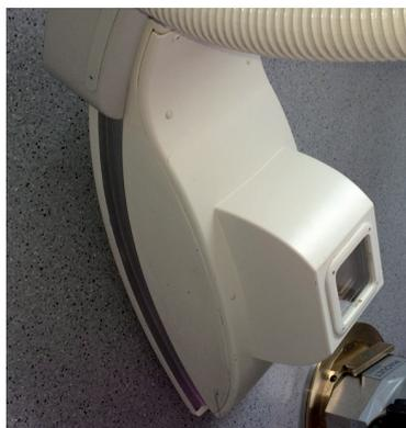
*Bild 5: Spalten und Vertiefungen führen zu einer schwierigen Reinigung.*
