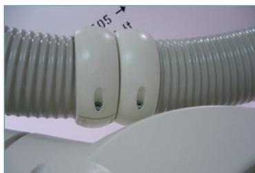
*Bild 2: Rillenzwischenräume und Schraubenvertiefungen sind nur schwer zu reinigen.*
