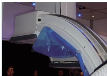
*Bild 6: Die Reinigung des Führungssystems des C-Bogens gestaltet sich als schwierig.*
