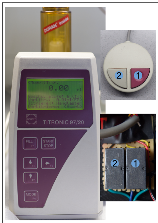
Abbildung 2: Automatische Bürette mit Handtaster, durch eine Printrelais-Schaltung ersetzt: 1 = Dosieren, 2 = Befüllen.
