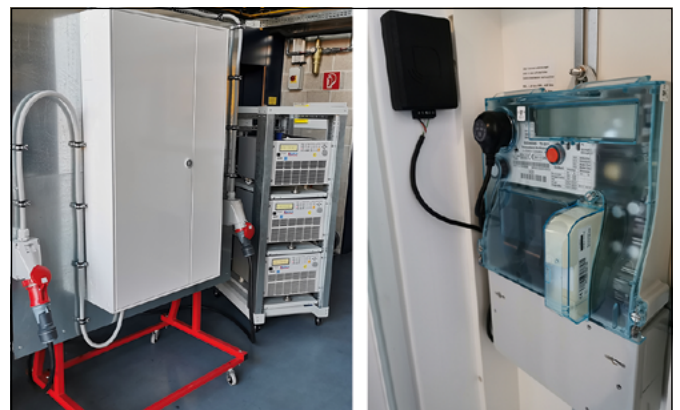
Abbildung 1: Testplattform für elektrische Energie (links) und zu prüfendes Messgerät im Zählerschrank (rechts)
