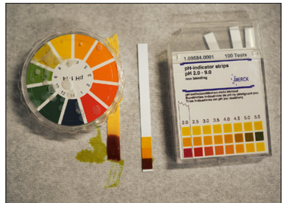
Abbildung 4: Supersaure Lösung geologischer Herkunft: a) RuO 2 -pH-Sensor mit Platindraht-Gegenelektrode. b) pH-Farbindikatoren außerhalb des messbaren Bereichs.
