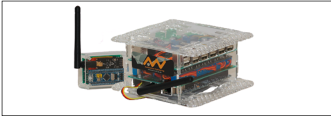
Abbildung 2: Messsystem für Energieverbrauch
