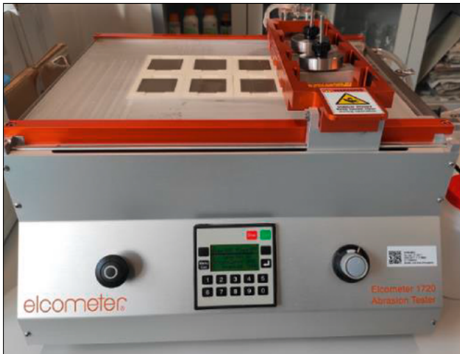
Abbildung 5: Aufbau der Wasch- und Abriebfestigkeitsprüfung mit dem Elcometer 1720
