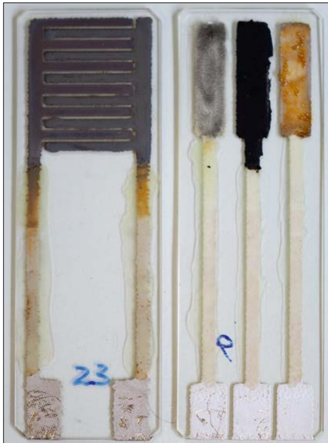
Abbildung 1: Bauarten der Sensoren. Links: Interdigitalstruktur mit Ag | AgCl-Strang und RuO 2 -Strang. Rechts: Dreielektrodenanordnung aus Epoxidharz-Grafit, RuO 2 /Ethylcellulose und Ag | AgCl mit Epoxidharz-KCl
