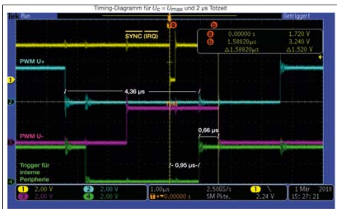
Abbildung 5: Synchronisation interner Peripherie bei positiver Flankentriggerung am Beispiel eines Motorstranges
