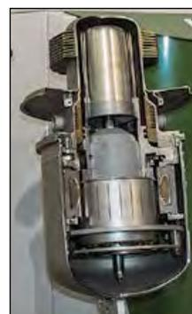
Abbildung 3: Microgen-Stirlinggenerator
