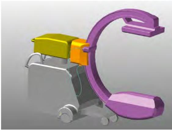
Abbildung 2.3: MKS – Kabel vernetzt mit 94 linearen Balkenelementen
