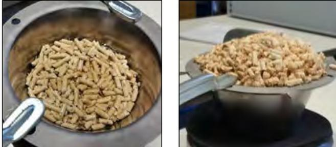
Abbildung 4 a und 4 b: Pellets mit Wasser nach 0 und 10 Minuten
