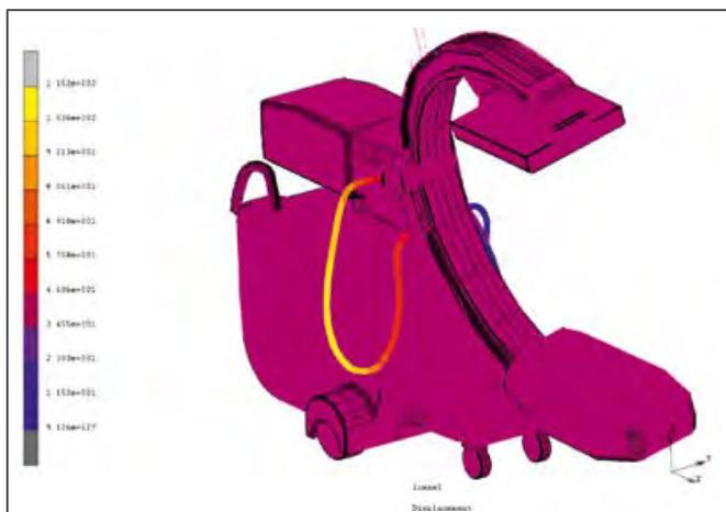
Abbildung 2.1: FEM – Kabel vernetzt mit 54000 linearen Tetraederelementen
