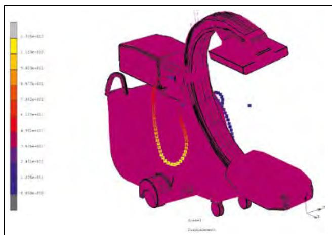
Abbildung 2.2: FEM – Kabel vernetzt mit 109 linearen Balkenelementen
