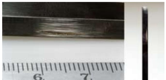
Es trat furchiger Abrieb auf, hervorgerufen durch losgelöste Partikel, die sich in die Oberfläche eingruben. Teilweise fielen diese Auswerfer bereits während des Dauerlaufs aus. Dieses Fehlerbild war nicht auf eine Materialpaarung eingrenzbar.
