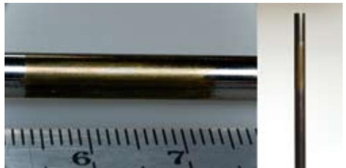
Es trat Reibkorrosion auf (Passungsrost). Durch Abrieb entstandene Partikel korodieren im Spalt zwischen Formeinsatz und Auswerfer. Diese Fehlerart wurde nur bei den Auswerfern ohne Beschichtung gefunden.
