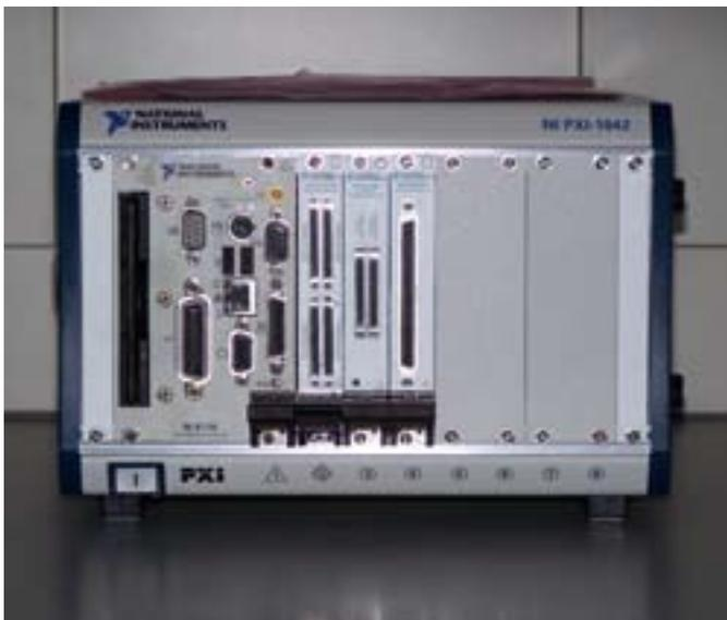
Abbildung 3: Industrie-PC zur Steuerung, Regelung und Messdatenerfassung
