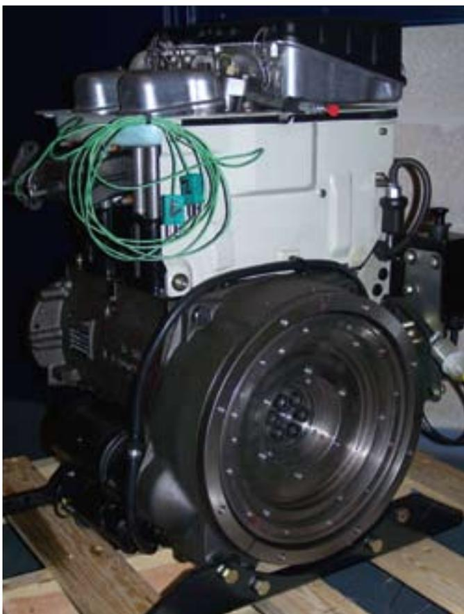
Abbildung 1: Versuchsmotor HATZ 2M41 für die Common-Rail-Applikation
