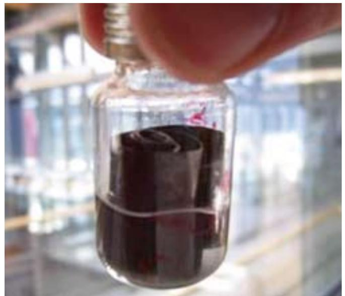
Abb. 2: Eine mit Aktivkohle beschichtete Aluminiumelektrode eines Superkondensators muss im Langzeittest ihre chemische Stabilität und Tauglichkeit erweisen.
