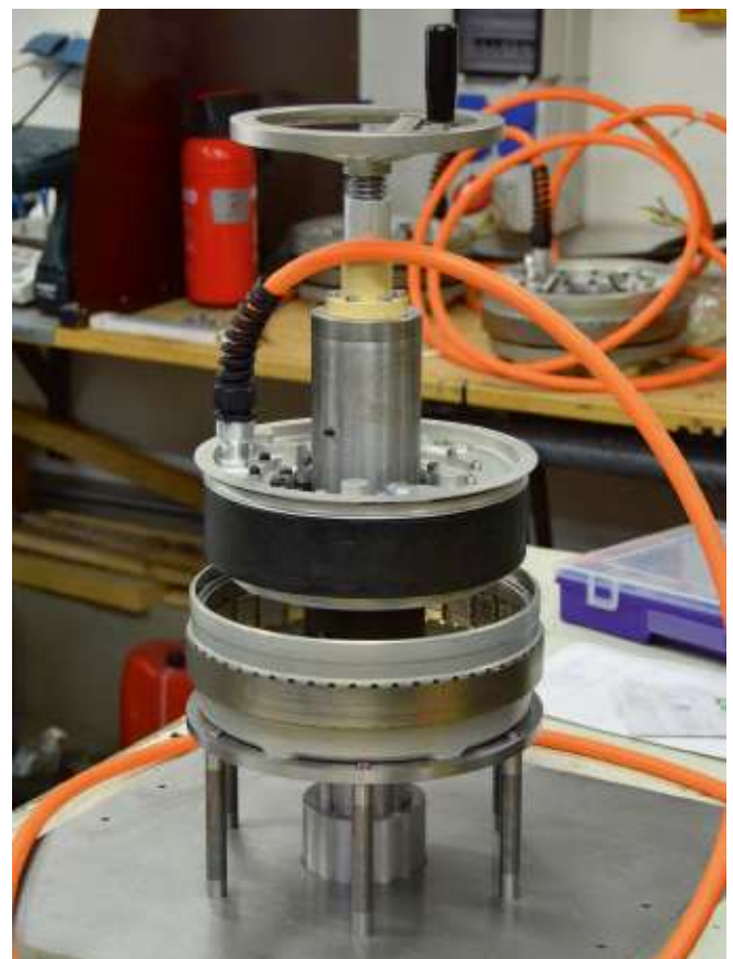
Abbildung 4: Montagevorrichtung für den Radnabenmotor
