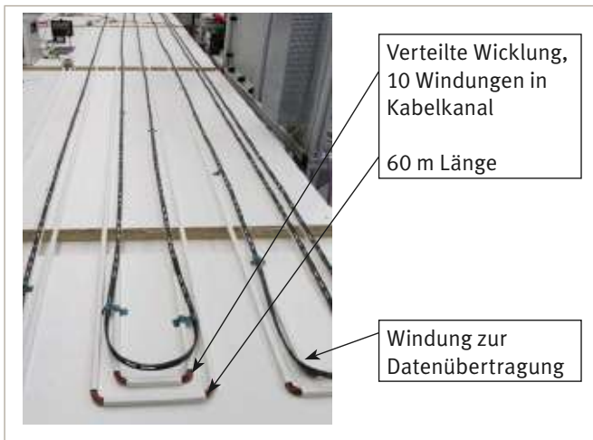
Abbildung 5: Laboraufbau der verteilten Wicklung
