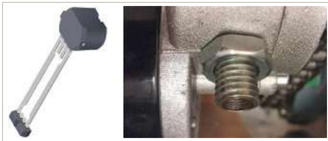
Abbildung 8: Zahnradsensor mit Einbauort im Getriebe
