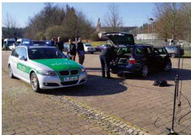
Abbildung 1: Versuchsanordnung zur Messung und Aufnahme der verwendeten Warnsignale
